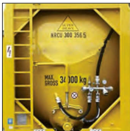
شکل ۹: شیرهای اهرمی و محفظه خروجی کانتینر
