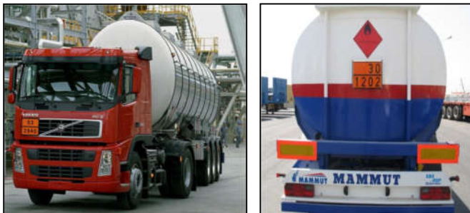
شکل ۵: نحوه قرار دادن تابلوهای نارنجی رنگ بر روی وسایل نقلیه حامل ماده خطرناک
