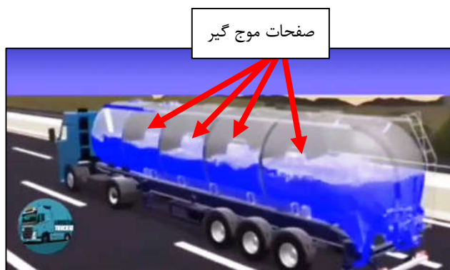
شکل ۱۱: نقش و تاثیر صفحات موج گیر در هنگام حرکت تانکرها
