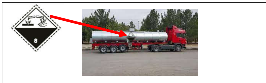
شکل ۶: تانکرهای استیل مخصوص حمل مواد خورنده
