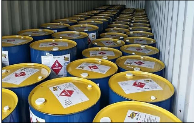
شکل ۲: استفاده از دیواره های بارگیر جهت مهار نمودن بشکه ها
